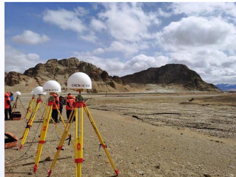
华测北斗高精度接收机在珠峰GNSS控制网点作业
